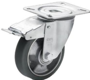
Las nuevas **ruedas** RE.F5-ESD de Elesa+Ganter incorporan bandas especiales de poliuretano moldeado que tienen una resistividad eléctrica inferior a  $10^9 \Omega$ , es decir, impiden la acumulación de carga electrostática.
