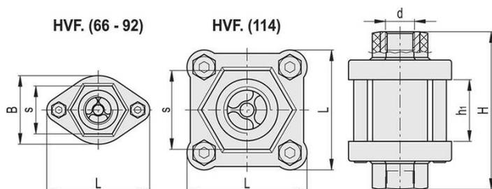
Elesa + Ganter ha introducido recientemente el nuevo HVF, visor indicador de flujo, que se utiliza para comprobar el paso de un líquido a través de una tubería y su estado real (Color, presencia de partículas, contaminación, densidad etc ...).
