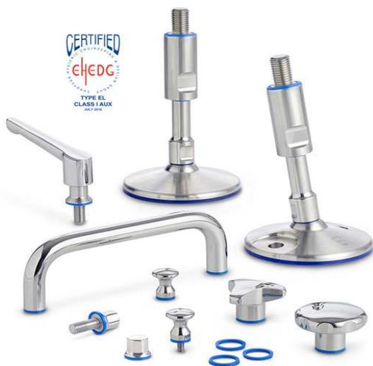
El **acero inoxidable** - con superficies pulidas - es el material utilizado en todos estos casos. La **rugosidad máxima de la superficie se mantiene por debajo de Ra 0,8 µm**, de manera que las partículas de suciedad y gérmenes no pueden adherirse y pueden ser eliminadas completamente de forma fiable durante la limpieza.
