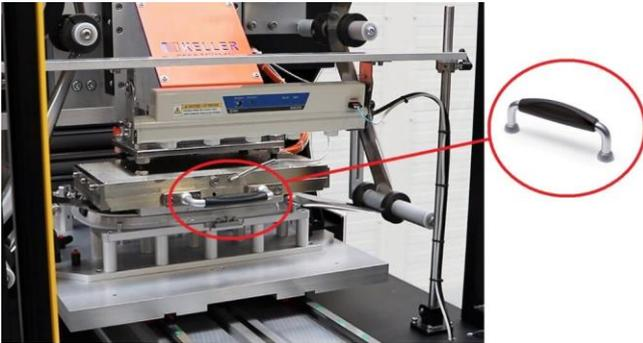
*Aplicación del asa MMT. en la máquina HS K-Desk Precision*
