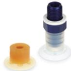
Para la manipulación de hojas de papel y etiquetas, y para la industria de papel en general. La presencia del laberinto moldeado en la superficie de la ventosa proporciona un agarre más eficaz del producto a manipular; las ranuras permiten que el vacío se distribuya uniformemente sobre la superficie del producto, evitando que la hoja o el envase sea succionado por las ventosas.
