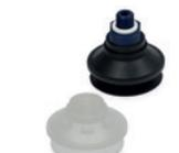
Diseñadas para retirar y agarrar hojas de papel y cartón, láminas delgadas y paneles de madera, incluso en superficies irregulares o inclinadas. El fuelle reforzado (más ancho y más grueso) permite una mayor fuerza de elevación, así como mayor resistencia a la abrasión y al desgaste, prolongando así la vida útil.
