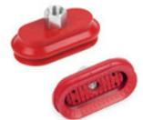
Para el sector de robótica automatriz y para superficies como chapa metálica o vidrio. El laberinto moldeado proporciona un alto nivel de agarre de la superficie de carga incluso en presencia de líquidos (aceite y agua). El fuelle se pliega sobre sí mismo al entrar en contacto con la superficie de carga, elevando la carga respecto a la superficie.
