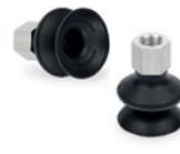
Para agarrar chapas metálicas y láminas de cristal, y para manipular paneles de madera o laminados plásticos. El tratamiento vulcanizado ofrece más resistencia a la abrasión, a las fuerzas de tracción y a los agentes ambientales agresivos, lo que garantiza un menor desgaste del caucho. El fuelle se pliega sobre sí mismo al entrar en contacto con la superficie de carga, elevando la carga respecto a la superficie.
