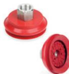
Para el sector de robótica automatriz y para superficies como chapa metálica o vidrio. El laberinto moldeado proporciona un alto nivel de agarre de la superficie de carga incluso en presencia de líquidos (aceite y agua). El fuelle se pliega sobre sí mismo al entrar en contacto con la superficie de carga, elevando la carga respecto a la superficie.
