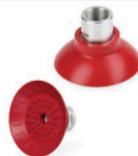
Para el sector de robótica automatriz y para superficies como chapa metálica o vidrio. La flexibilidad del labio de agarre las hace adecuadas para superficies planas, cóncavas y convexas. El laberinto moldeado en la superficie de la ventosa proporciona un alto nivel de agarre de la superficie de carga incluso en presencia de líquidos (aceite y agua).
