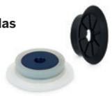
Para la manipulación de baldosas. También se puede utilizar con productos de vidrio, mármol y hormigón. Labio especialmente flexible para superficies planas lisas o rugosas, cóncavas y convexas, incluso muy delgadas. Las ranuras en la superficie de la ventosa permiten un agarre superior y una sujeción más eficaz.
