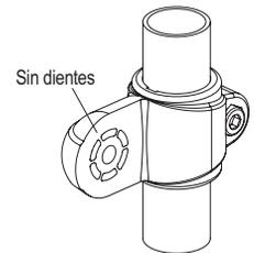
El casquillo reductor, equipado con un chavetero que encaja en la ranura de la abrazadera en la que está montado, permite el montaje con tubos de diámetros inferiores desde 12 mm.
