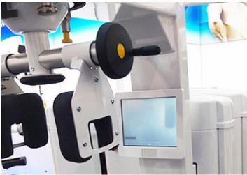
Aplicación de volantes VDS+I con empuñaduras abatibles de seguridad
